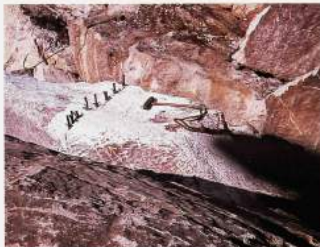
Herdade da Vigária (Vila Viçosa). Marcas, da época da extração de blocos por introdução de cunhas como se vê na fotografia em cima.
