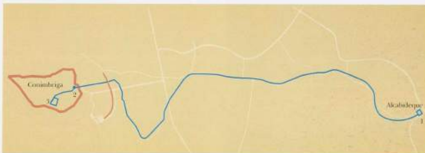
Traçado do aqueduto de Conimbriga desde a nascente de Alcabideque (1) ao termo ao sul da Fozna (3), passando pelo local de distribuição (2).
