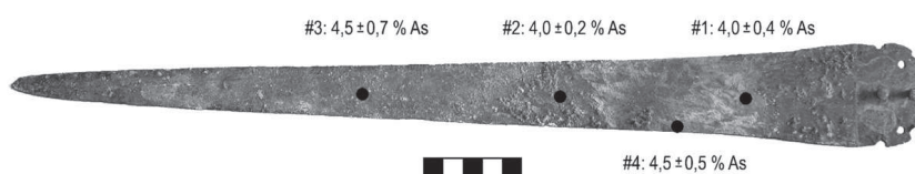
Fig. 19 – Resultados (médias e desvios padrão) das análises de micro-EDXRF efetuadas nas áreas #1 a #4 da espada da Horta do Folgão.
