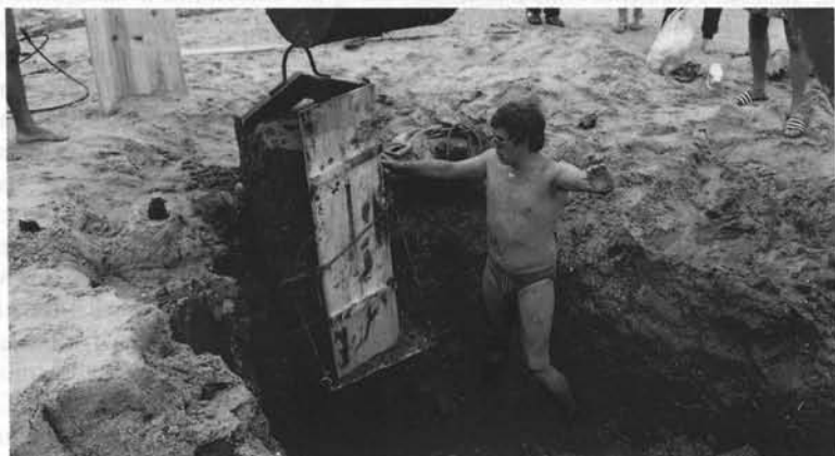
Fig. 32 — Recuperação de um paralelepípedo de sedimento com a estaca N3 no interior.
