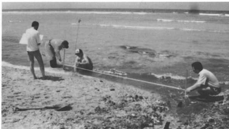
Fig. 13 — Determinação de perfis através de sondagens com vareta de aço.
