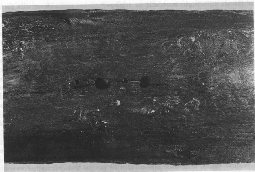
Fig. 13 — Pormenor dos orifícios do fundo.
