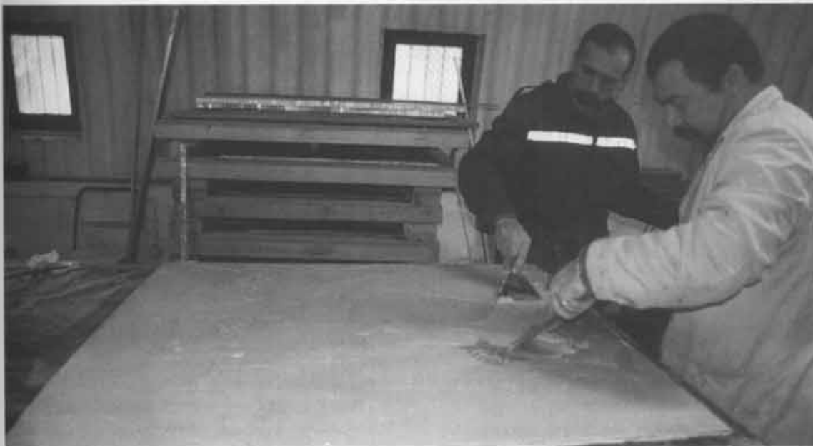
Fig. 12 – Preparação do tardo de um painel do mosaico das musas com “Multipox” (componentes A e B) para receber o favo de alumínio. 1999. (Fotografia da autora).
