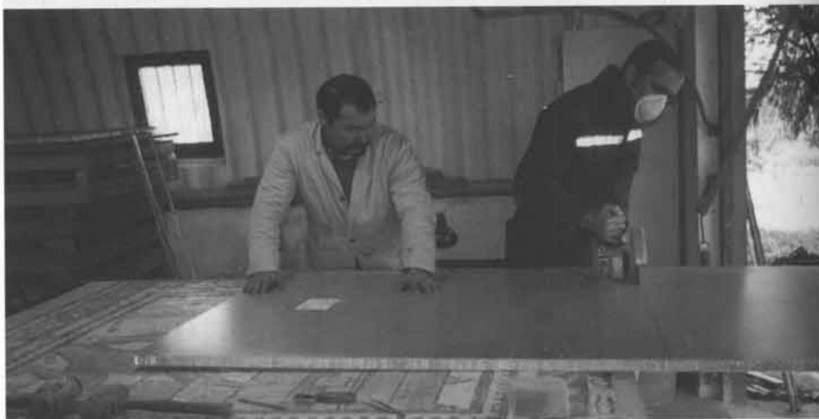
Fig. 13 – Corte do favo de abelha em alumínio (composição: favo de alumínio revestido de uma camada de polyester e fibra de vidro). (Fotografia da autora).
